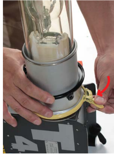
ボディ側の黄色い固定リングの中にアダプターの端を入れて、リングのロックをかけて固定する。
