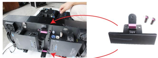
マトリックス2台を密着させて並べ、写真右の部品で二箇所固定する。
