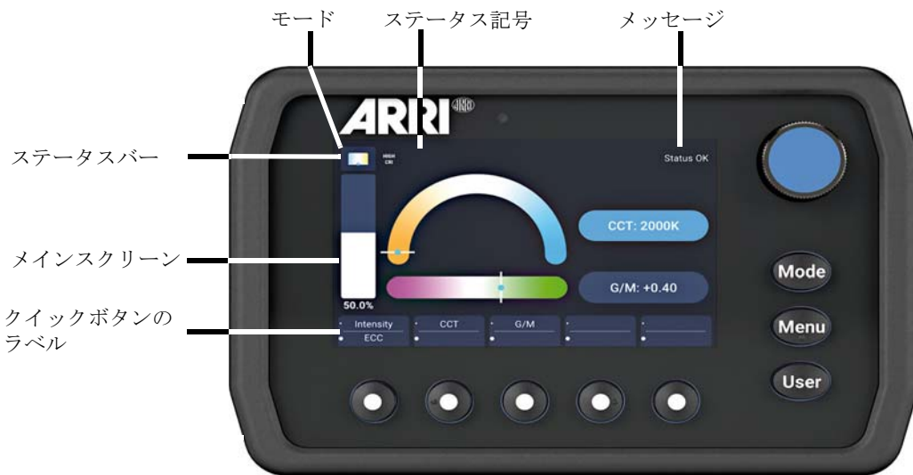
CCTモード、ディスプレイはメニューを閉じている状態
