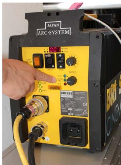
6：LAMP スイッチを ON にして。点灯を確認する。
