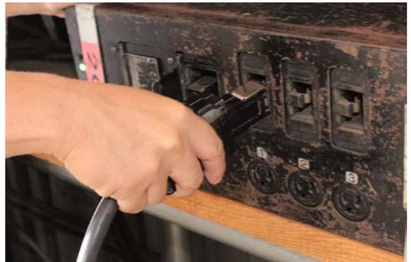
4：バラストの電源スイッチを ON にして、セーフティーランプが点灯している事を確認する。 ※セーフティーランプが消えている場合は点灯できません。
