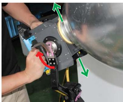
ロックレバーを上げて、上下の振りを調節します。
