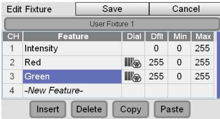
3. エンコーダーを押し、灯体の一番目のチャンネルに情報を入力します。Stage CLは次のパラメーターに対応しています：インテンシティ、レッド、ブルー、グリーン、アンバー、ホワイト、クールホワイト、ウォームホワイト、色温度、ストロボ、パン、チルト、ズーム、シアン、マジエンダ、イエロー、カスタム1-4
