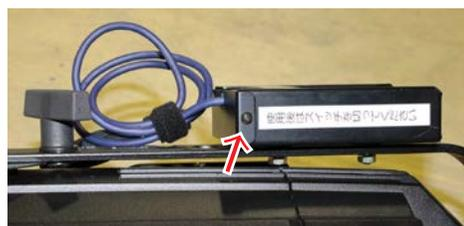
1: DMX コントローラー両脇 (赤矢印部分) のネジをプラスドライバーで外して、コントローラーを固定しているカバーを外します。
